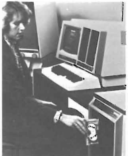
L'inserimento del disco rigido nel sistema Micrapoint II consente una capacità di memoria molto più elevata.
