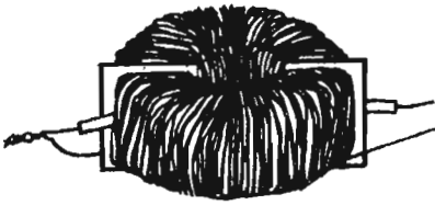
Fig. 3 - Bobine telefoniche toroidali (surplus) da 88 mH con presa centrale da impiegare sia nel filtro di figura 1 sia nel discriminatore di figura 2.
